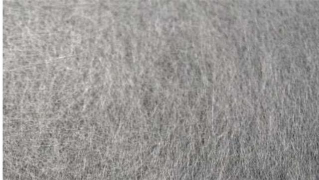
Velo de fibra de vidrio "non woven" clase E indicado para obtener paredes lisas de alta calidad en interiores evitando su fisuración. Refuerzo de paramentos y calidades de pintura (estuco, lacados, etc.)
