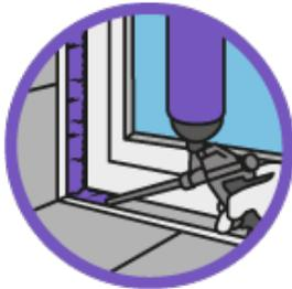
OLIVÉ PU UNIVERSAL PISTOLA se emplea para aislar y sellar marcos de ventanas, juntas y umbrales de ventanas. Así mismo se emplea para fijar marcos de puertas de madera, para aislar y llenar huecos y diversas cavidades, tubos y conductos de aire acondicionado, sanitarios, calefacciones e instalaciones eléctricas. Se usa también para fijar estructuras prefabricadas y paneles de aislamiento
